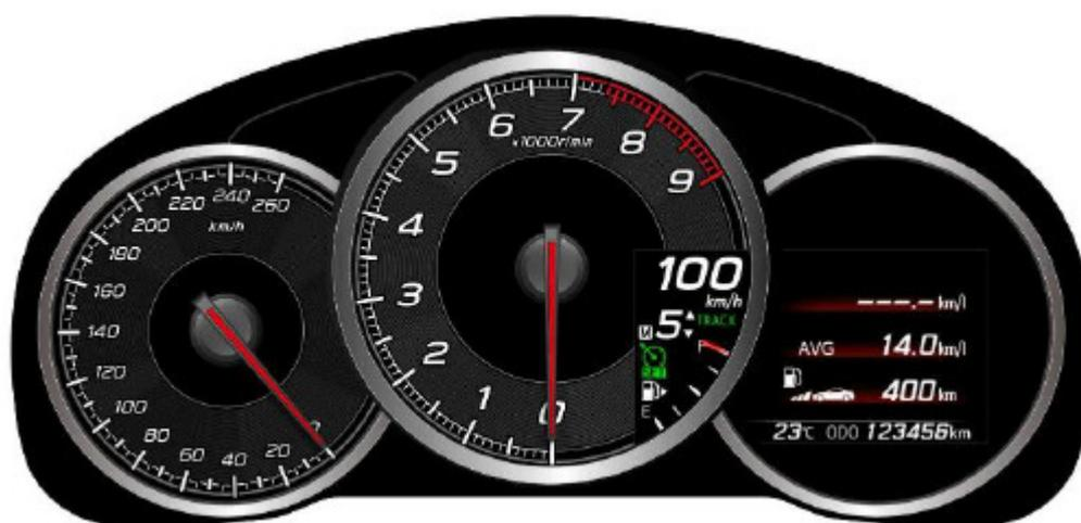
Il nuovo schermo inserito nel cockpit mostra dal consumo istantaneo al livello della temperatura dell'acqua e dell'olio motore, dal livello di carica della batteria al g-monitor
